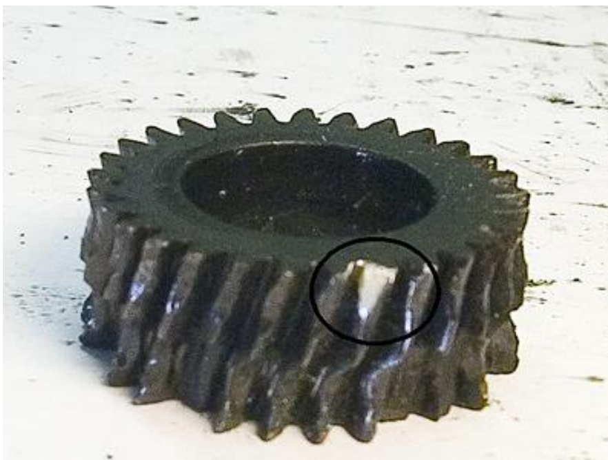
Фото 8. Спленный угол зуба сателлита.
