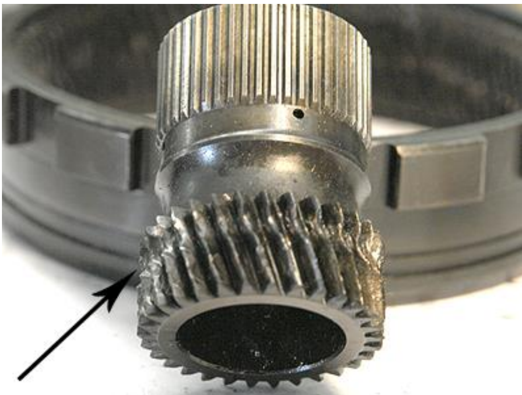
Фото 7. Поврежденные зубья солнечной шестерни планетарного ряда.
