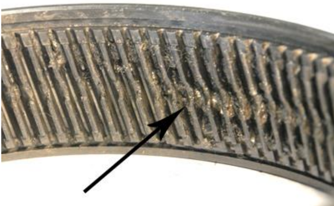
Фото 5. Поврежденные зубья коронной шестерни планетарного ряда.
