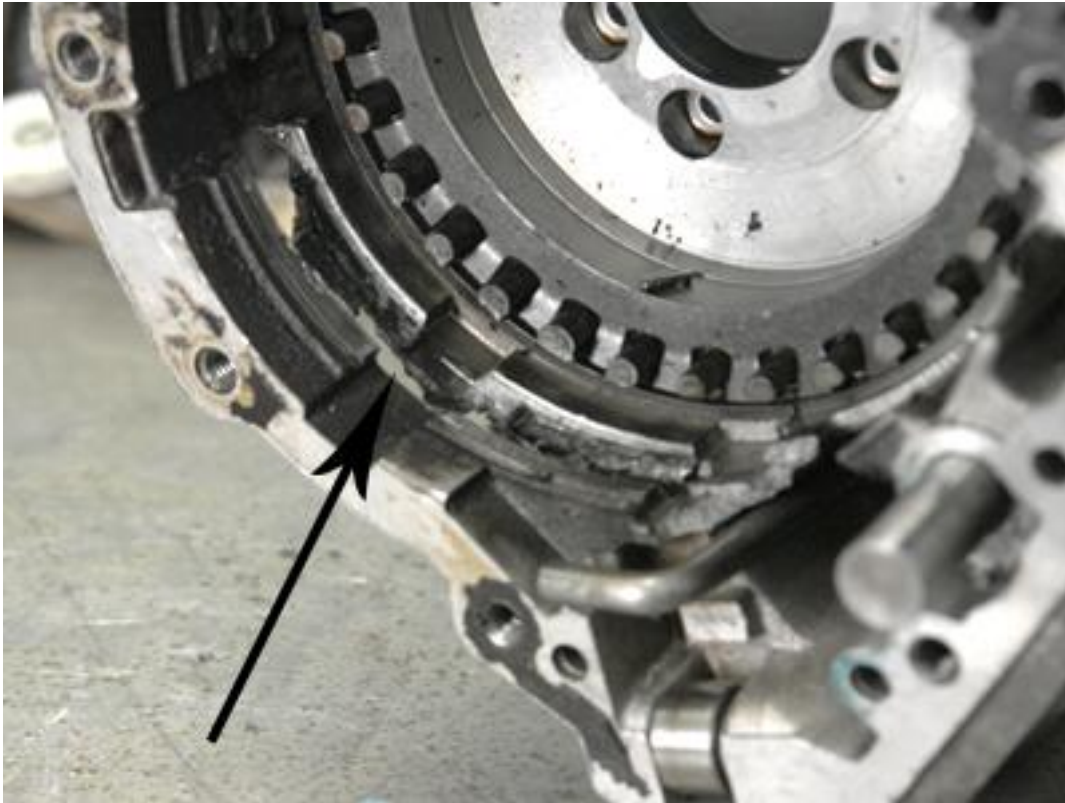
Фото 13. Расплавленный алюминиевый картер АКП в районе фрикционного сцепления 5-ой передачи.
