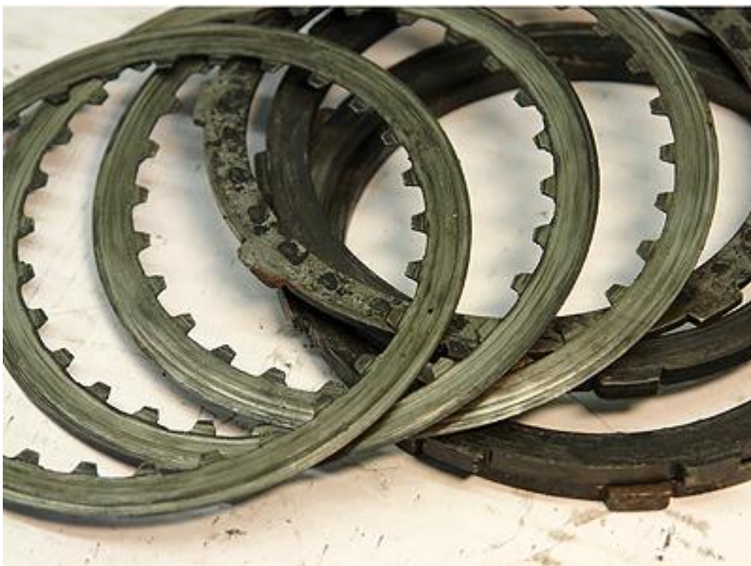
Фото 12. Сгоревшие до металлической основы фрикционные диски включения 5-ой передачи.
