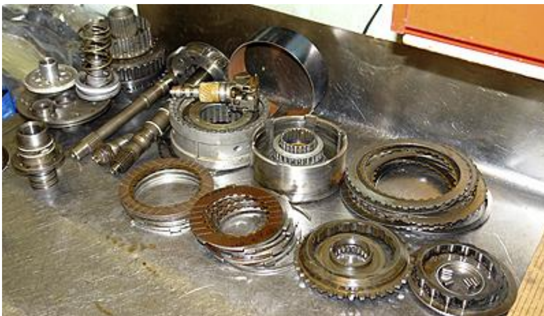
Фото 3. Детали 4-х ступенчатой части АКП. Однако детали 5 передачи АКП имели значительные следы износов и повреждений, особенно элементы планетарной передачи (Фото 4).
