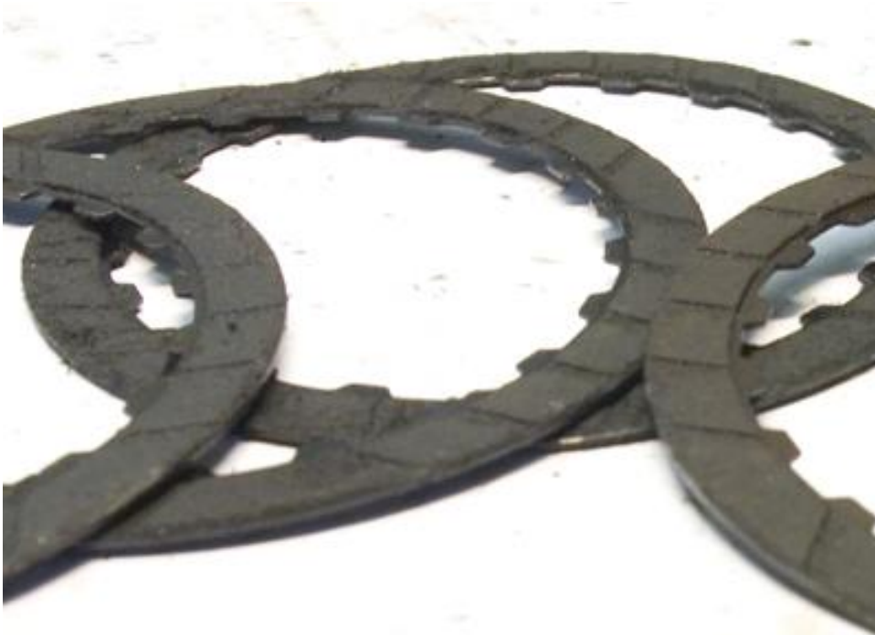
Фото 14. Не сгоревшие диски выключения 5-ой передачи, фрикционный слой изуродован механически, продуктами разрушения планетарного ряда.
